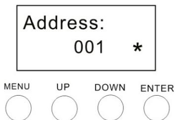
Панель управления отображает текущее состояние устройства. С ее помощью можно выбрать режим работы, а также дополнительные функции. Подробная схема функций панели управления приведена в разделе «схема меню» на следующей странице.
