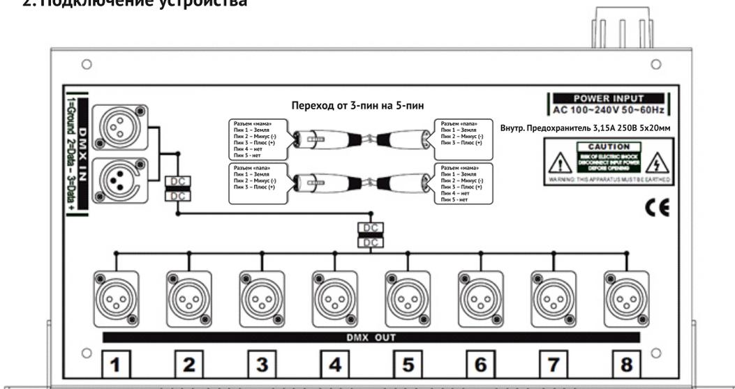
Вход DMX: подключите устройство, передающее сигнал DMX
