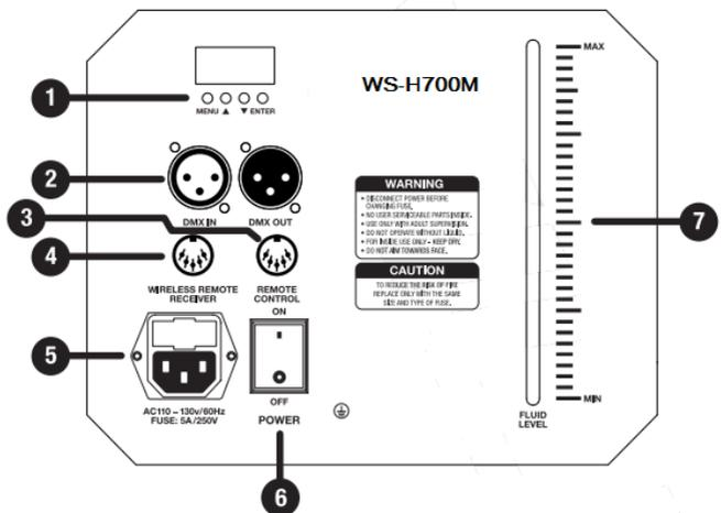
1. Встроенный цифровой дисплей для быстрого доступа к настройке каналов DMX, изменения режима работы, изменения скорости вращения вентилятора и изменения объема выводимого тумана.
